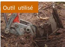
Le travail du sol se réalise en potet avec une mini pelle et un culti-sous soleur Becker. On travaille ainsi le sol sur un carré de 1,5 m de côté.
