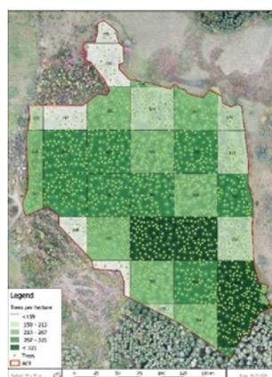
La télédétection désigne, dans son acception la plus large, la mesure ou l'acquisition d'informations sur un objet ou un phénomène, par l'intermédiaire d'un instrument de mesure n'ayant pas de contact avec l'objet étudié. De fait, les techniciens forestiers réalisent déjà de la télédétection au quotidien grâce aux télémètres laser permettant de mesurer la hauteur des arbres par exemple.
